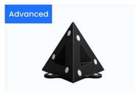
ピラミッドマーカー (磁着式) 明確な特徴のない広い平面に最適で、頂点部分の接触面積が小さいため、物体を支えて複数の角度からスキャンを行うことが容易になります。
