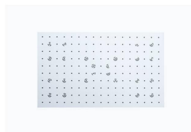
标定板 用于标定 MetroX 3D 扫描仪。
